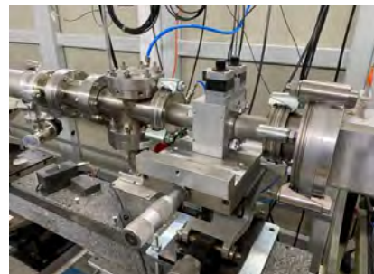
Рис. 2.7. Нерассеивающие щели: (а) конструкция нерассеивающей створки, (б) вторая щель, (в) третья коллимирующая щель
